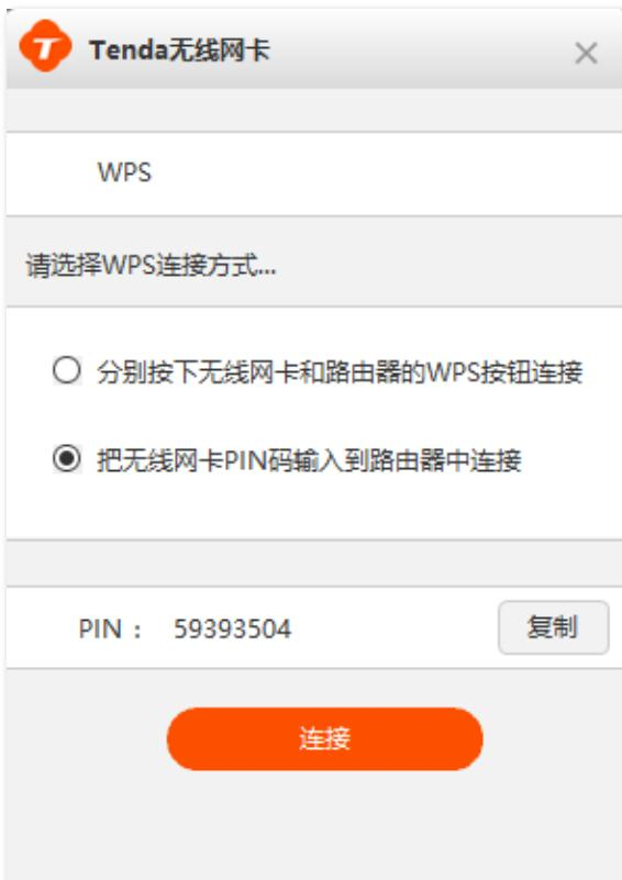
**步骤 3** 2分钟内，启用路由器的 WPS-PIN 功能（可参考路由器的说明书），将无线网卡的 PIN 码粘贴到 WPS 页的 PIN 码框。
